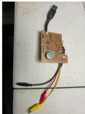
5) Construya una punta lógica, use alambre calibre 20 y una resistencia de 1000Ω. Marque los polos + y - con alambres de distinto color (preferiblemente rojo y negro). Siga el diagrama adjunto.
